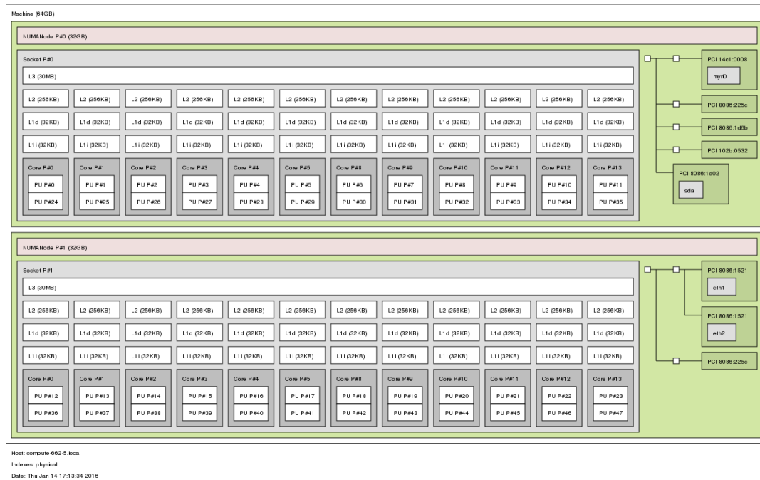
Figura 51: Resultado do comando lstopo para as máquinas NUMA compute 662.
