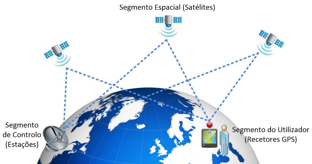
Figura 12 – Esquema de funcionamento - GPS
