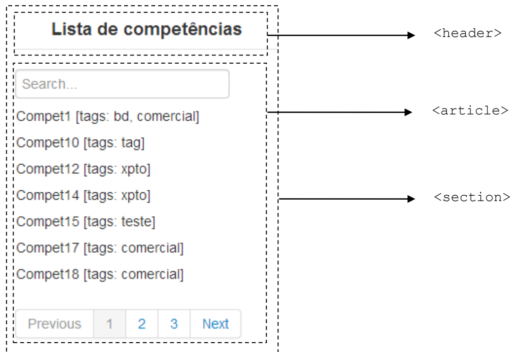
Figura 31 – Esquema que representa a estruturação do código HTML das listas de competências
