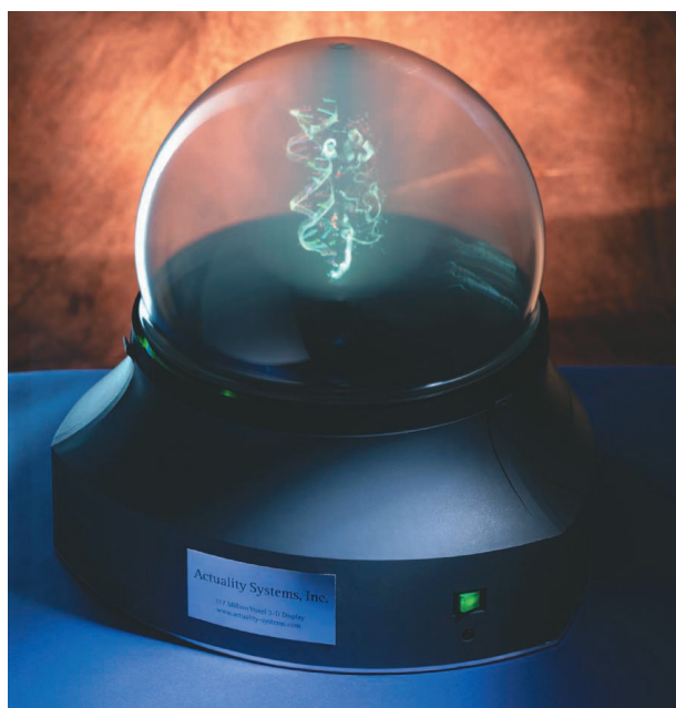
Figura 2.16: Dispositivo volumétrico de varrimento desenvolvido pela Actuality Systems, Inc. (Imagem retirada de [Favalora, 2005])
