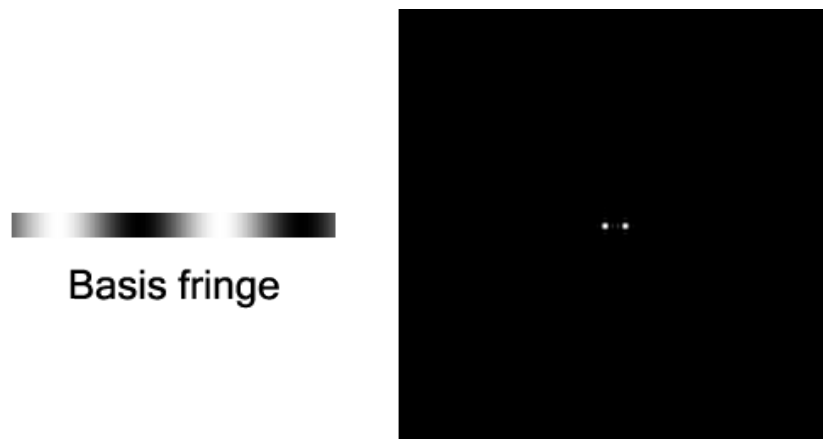
Figura 4.7: Simulação da iluminação de uma basis fringe . Um ponto de luz é difractado formando as duas primeiras ordens de difracção.
