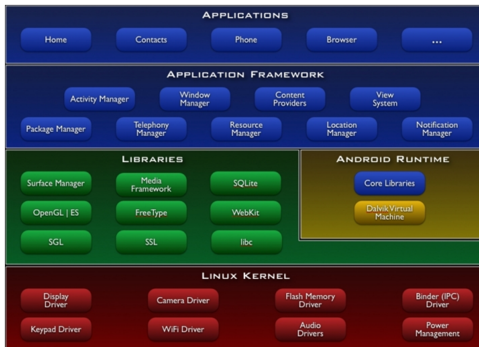
Figura 2.7: Arquitectura do Android[3]
