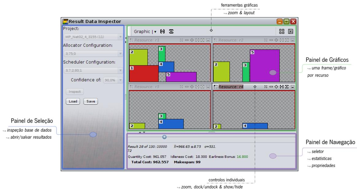
Figura 5.3: Detalhe do Result Data Inspector.
