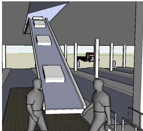
Imagem 23 - Detalhe do tapete de abastecimento de sacos
