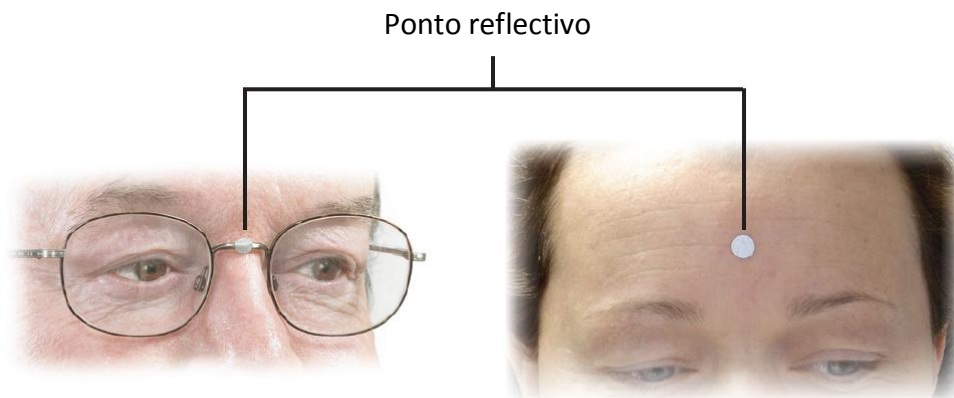
Figura 15 - Material reflector utilizado no Tracker Pro
