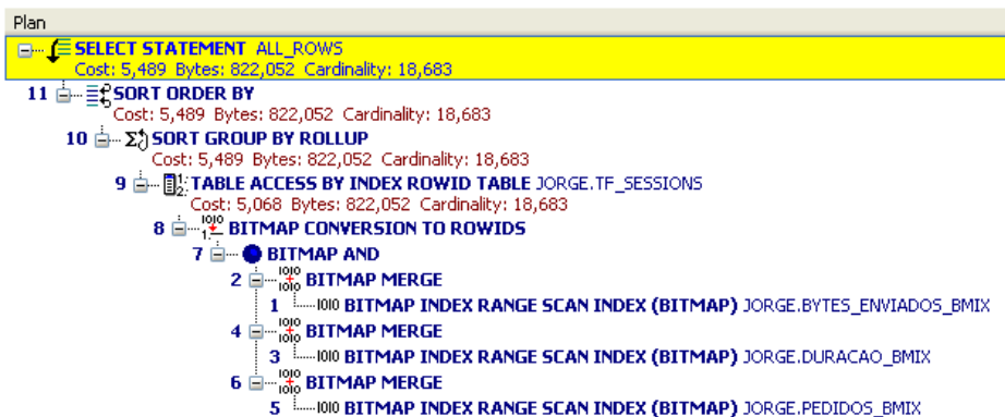
Figura 31 - Plano de execução da query do tipo 2 categoria 1 com índices bitmap .
