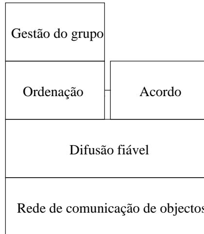
Figura 7.1: Estrutura de uma pilha de protocolos completamente configurada.
